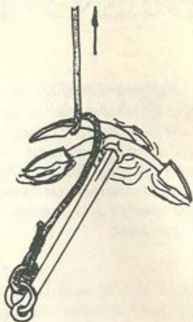
33. ábra. Horgonyra csavarodott kötéll
