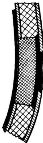
217. ábra. Szendvicsszerkezet javítása
