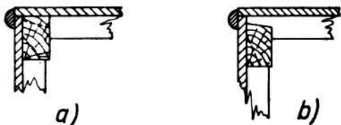
105. ábra. A bordavégek beerősítése
